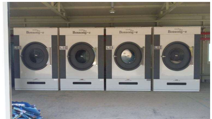
Dàn máy sấy 100kg/mẻ trong nhà máy công nghiệp
